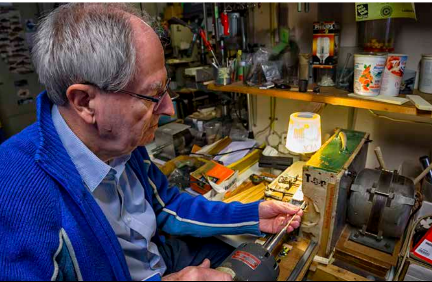
Iedere antenne wordt machinaal perfect rond geschuurd.
